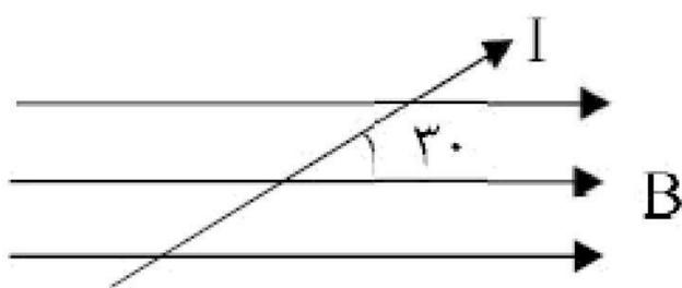
۱۸- سیمی حامل جریان ۵A مطابق شکل مقابل، در میدان مغناطیسی یکنواخت به بزرگی ۴۰۰G قرار دارد. اندازه نیرویی که بر ۲۰cm از این سیم وارد می‌شود چند نیوتن و جهت آن به کدام سمت است؟
