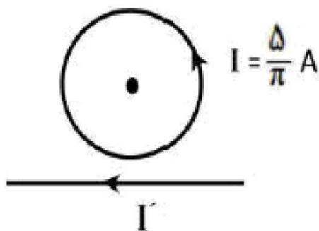
۴- در شکل داده شده، شعاع حلقه  $5 \text{ cm}$  است. اگر میدان مغناطیسی حاصل از سیم راست در مرکز حلقه برابر  $0.6 \text{ G}$  باشد، میدان خالص در مرکز حلقه، چند تسلا و در چه جهتی است؟
