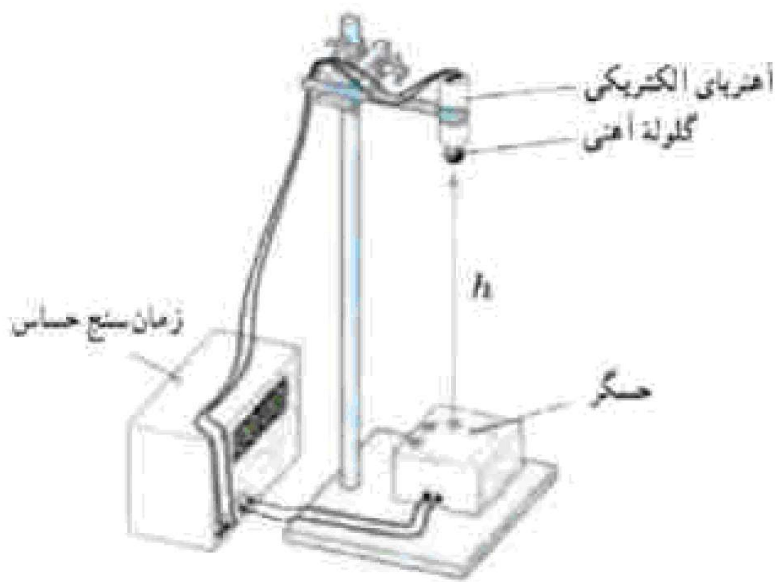
۲۲- با استفاده از دستگاه شکل مقابل، شتاب گرانش زمین را در  $\frac{m}{s^2}$  ۹/۸ اندازه گرفته ایم.
